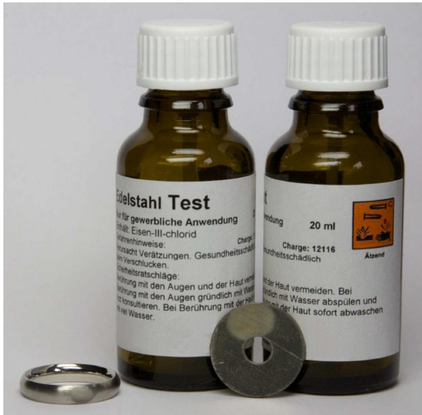
Der Edelstahltest wird angewendet zur Unterscheidung von Edelstahl von Silber und Weißgold.
